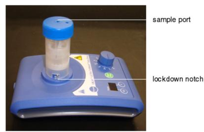
Figure 21 SOLiD<sup>™</sup> ePCR Tube on the ULTRA-TURRAX<sup>®</sup> Tube Drive from IKA<sup>®</sup>.
